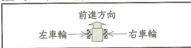
〔図1〕 ロボットを真上から見た図
